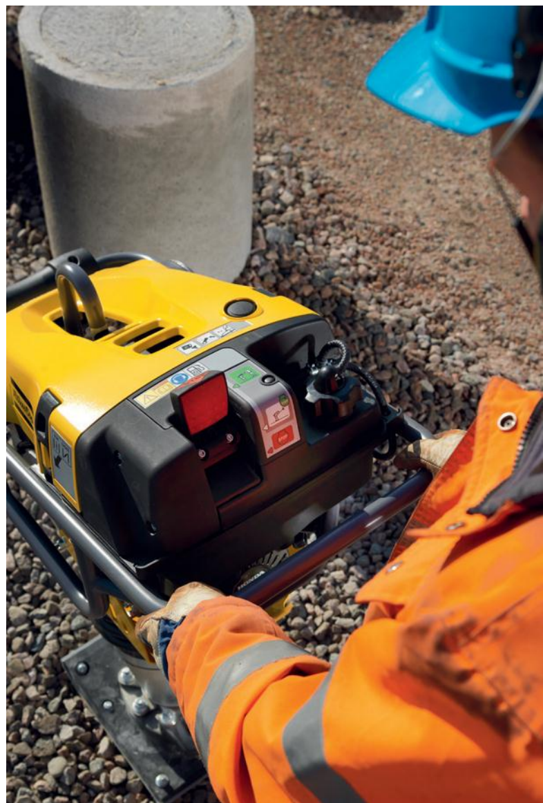
Atlas Copco stampers met Honda GX100-motoren hebben nieuwe carburateurs die een volle acceleratie van stationair naar maximaal toerental zonder onderbreking mogelijk maken.
